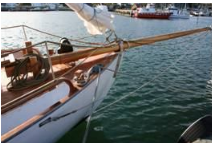
Fester og arrangement for enkel håndtering av klyverbom ble laget og montert ved kai.
